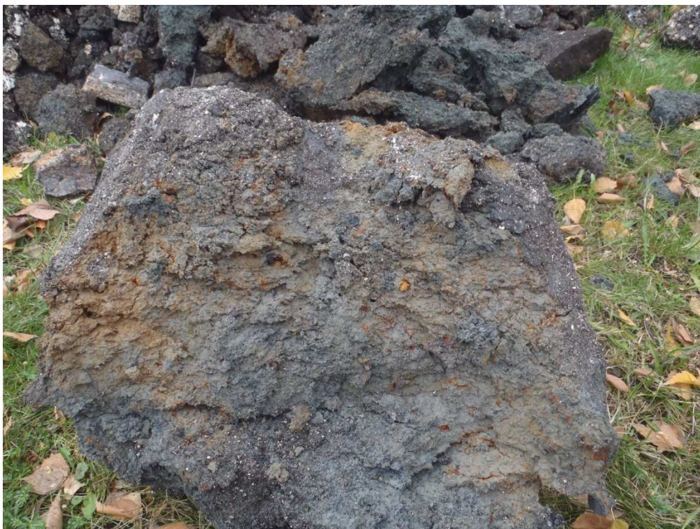
Foto 2: Kopaná sonda KS1: interval: 3,80 – 3,90 m p.t.: jíl s vysokou plasticitou, lokálně s organickou příměsí, silně vápnitý, marinní (mořský), stáří: terciér – miocén.
