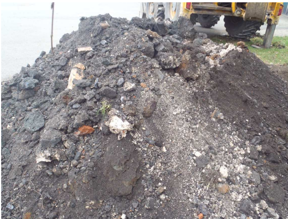
Foto 1: Kopaná sonda KS1: interval: 0,70 – 3,80 m p.t.: navážka tvořená hlušinovou sypaninou s kusy strusky, cihly, šamotové cihly, žlutobílý jíl - rozložené šamotové cihly, úlomky uhlí.
