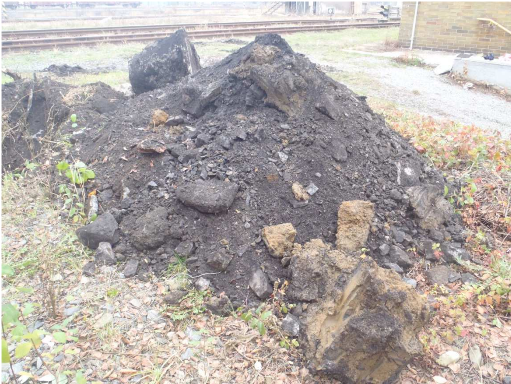
Foto 3: Kopaná sonda KS2: interval: 0,00 – 3,20 m p.t.: navážka tvořená hlušinovou sypaninou s kusy dřev, betonu, uhlí, papíru, textilu, strusky.
