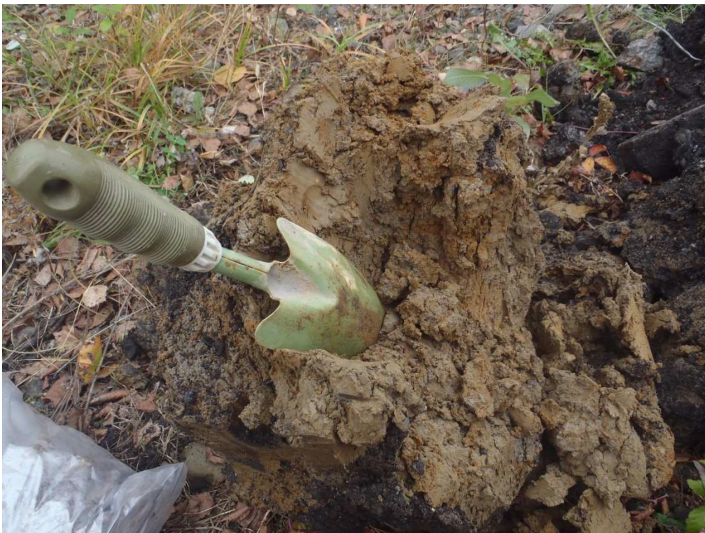
Foto 4: Kopaná sonda KS2: interval: 3,20 – 3,30 m p.t.: jíl se střední plasticitou, lokálně s organickou příměsí, marinní (mořský), stáří: terciér – miocén.
